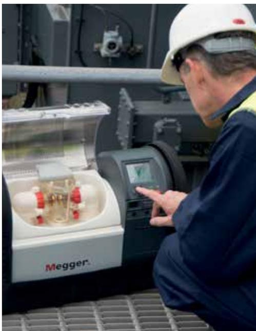
◀ L'huile isolante absorbe l'humidité au cours du temps, ce qui peut provoquer des pannes catastrophiques. Des mesures de routine de la tenue diélectrique sont donc nécessaires.
